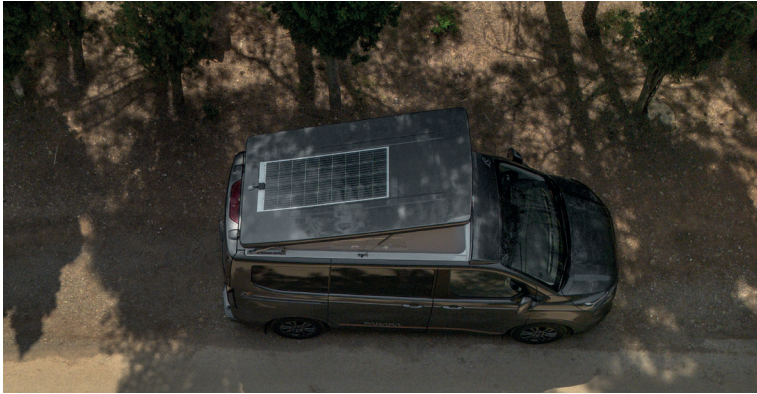
SOLARPANEL 185-Watt-Solarmodul mit MPPT-Laderegler und Ladeoptimierer.
