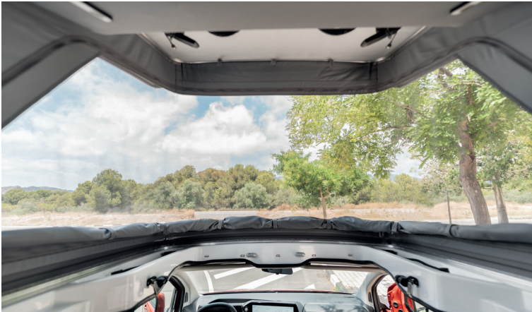
POP-UP PANORAMA AUFSTELLDACH Panoramastoff. Erhöht die Innenraumhöhe um 3 cm (Außenhöhe des Fahrzeugs +7 cm).
