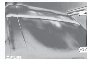
Eine sichere Tatsache, denn wir haben unseren Van in einer Klimakammer nach EN 1646-1 getestet. Dieser Test schreibt vor, dass im Fahrzeug bei einer Außentemperatur von  $-15^{\circ}\text{C}$  innerhalb von 4 Stunden nach der Einschaltung der Heizung eine Temperatur von  $20^{\circ}\text{C}$  erreicht werden muss.
