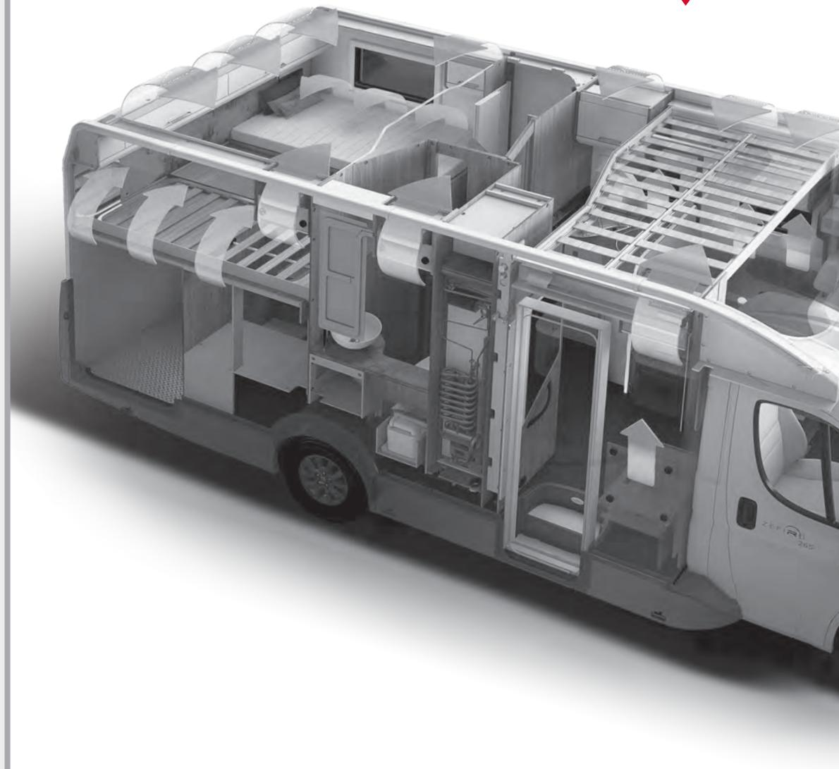
**Antikondensationsplatten** die im Wohn- und Schlafbereich von der Wand selbst in einem bestimmten Abstand installiert sind, lassen Luft und Wärme zirkulieren.
