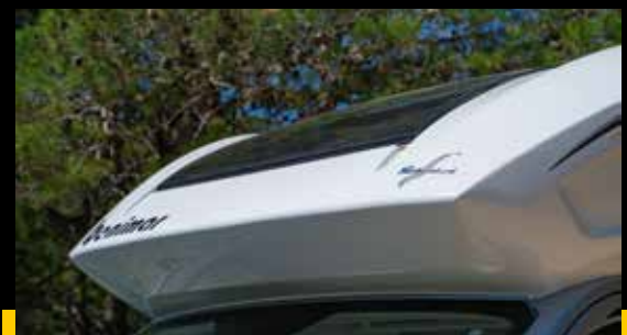
Der Aufbau unserer Baureihen Tessoro und Mileo besteht aus verstärktem Polyester und ist einteilig. Dies bietet eine bessere Beständigkeit gegen Ausdehnung als Kunststoff und somit eine bessere Beständigkeit über lange Zeit.
